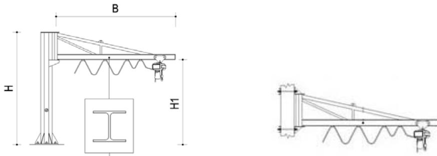
Realizzata con l'impiego di una trave in profilo laminato a doppio T sulla cui ala inferiore scorre il carrello porta paranco. Il braccio è dotato di uno o due tiranti per il sostegno del profilo che lo collegano al montante tubolare di rotazione. Può essere utilizzata in abbinamento con carrelli di traslazione a spinta, elettrici e meccanici.
